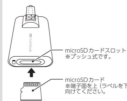
対応のmicroSDカードを、カチッとなるまで奥へ押して、本製品に挿入する
