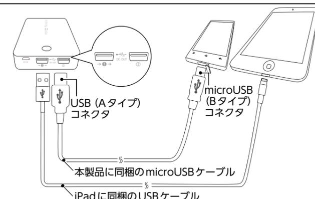
※最大出力電流は、ポート①が2.4A、ポート②が1.8Aです。同時給電時は、ポート①、ポート②合計で3.1Aです。
