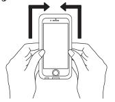
前面カバーの辺に沿って、取り付け用器具で押 さえ、隙間がないように閉める
